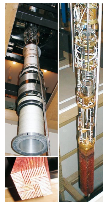
絶対零度まで0.00005 Kの超低温を実現する核断熱冷却装置
